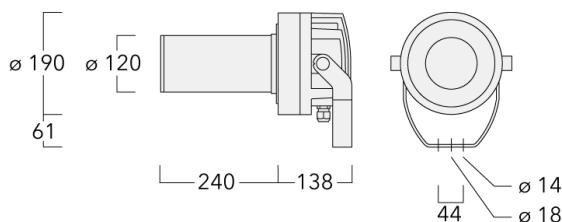
IP66. Classe I. IK07. Corps en fonte d'aluminium. Visserie inox avec traitement PCS. Protection contre la corrosion 5CE. Joint silicone. Verre de sécurité. Circuit LED installé en usine. (Dé)montage facile sans dérégler le train optique. Une entrée de câble (seconde entrée en option, sur demande). Driver électrique séparé thermiquement, protection surtension 6/6kV intégrée.
