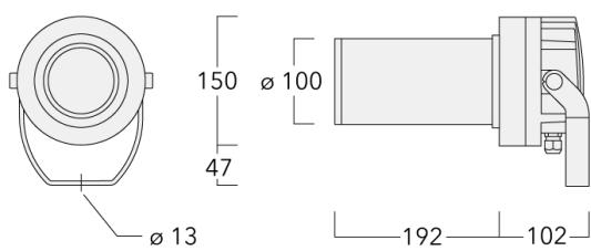
IP66. Classe I. Classe II sur demande. IK05. Corps en fonte d'aluminium. Visserie inox avec traitement PCS. Protection contre la corrosion 5CE. Joint silicone. Verre de sécurité. Circuit LED installé en usine. (Dé)montage facile sans dérégler le train optique. Une entrée de câble (seconde entrée en option, sur demande). Driver électrique séparé thermiquement, protection surtension 6/6kV intégrée.
