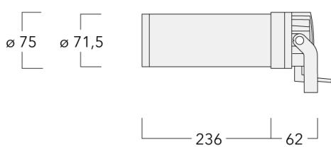
IP66, SKIII. IK07. Korrosionsbeständiger Aluminiumguss. PCS beschichtete Edelstahlschrauben. 5CE Korrosionsschutz. CCG® Silikondichtung. Sicherheitsglas. Elektronisches Betriebsgerät in externer vorverdrahteter Gerätebox (Konstantstrom). Gerätebox separat zu bestellen. Ein eingebauter Flanschstecker M8 x 1,5. Anschlussleitung 3 m. CAD-optimierte Technik zur Lichtlenkung und Entblendung. Eingebaute LED Platine.
