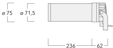
IP66, SKIII. IK07. Korrosionsbeständiger Aluminiumguss. PCS beschichtete Edelstahlschrauben. 5CE Korrosionsschutz. CCG® Silikondichtung. Sicherheitsglas. Elektronisches Betriebsgerät in externer vorverdrahteter Gerätebox (Konstantstrom). Gerätebox separat zu bestellen. Ein eingebauter Flanschstecker M8 x 1,5. Anschlussleitung 3 m. CAD-optimierte Technik zur Lichtlenkung und Entblendung. Eingebaute LED Platine.
