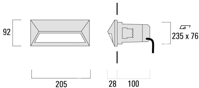
Für die Montage in Betonwände wird ein Einbautopf benötigt.
