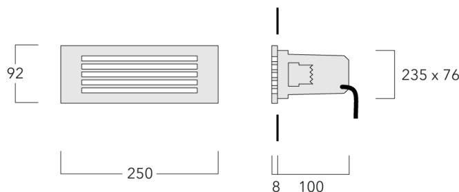
Pour le montage dans un mur en béton, nous conseillons l'emploi d'un boîtier d'encastrement. A commander séparément.
