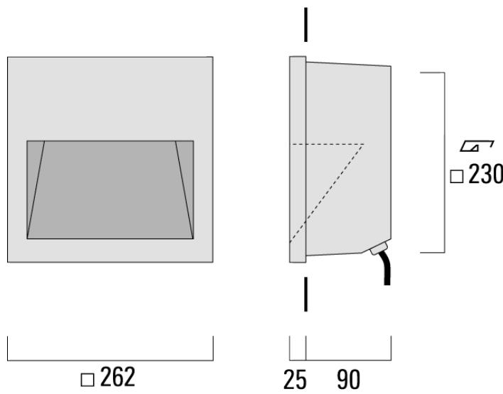
Pour le montage dans un mur en béton, nous conseillons l'emploi d'un boîtier d'encastrement. A commander séparément.
