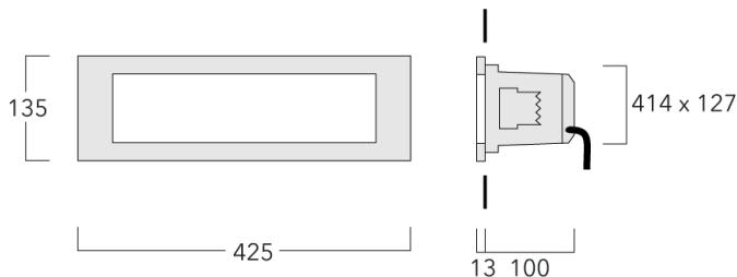
Pour le montage dans un mur en béton, nous conseillons l'emploi d'un boîtier d'encastrement. A commander séparément.
