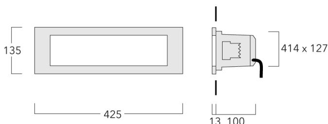
Pour le montage dans un mur en béton, nous conseillons l'emploi d'un boîtier d'encastrement. A commander séparément.
