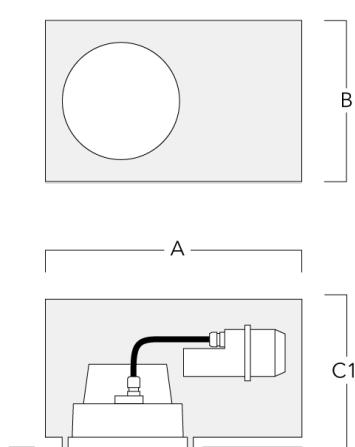
**Deckenleuchten****Einbautopf, bündig mit Schattenfuge**
