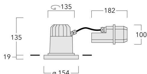
Pour le montage dans un plafond en béton, nous conseillons l'emploi d'un boîtier d'encastrement.
