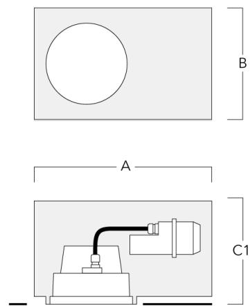
**Einbautopf, erhaben - reduzierte Einbautiefe**
