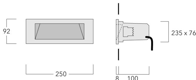
Pour le montage dans un mur en béton, nous conseillons l'emploi d'un boîtier d'encastrement. A commander séparément.
