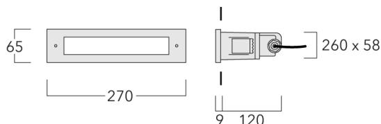
Für die Montage in Betonwände wird ein Einbautopf benötigt.
