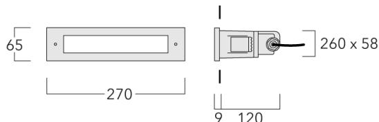
Für die Montage in Betonwände wird ein Einbautopf benötigt.
