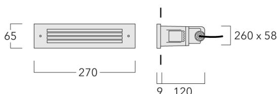
Pour le montage dans un mur en béton, nous conseillons l'emploi d'un boîtier d'encastrement. A commander séparément.
