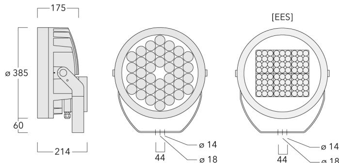
IP66. Classe I. IK07. Corps en fonte d'aluminium. Visserie inox avec traitement PCS. Protection contre la corrosion 5CE. Joint silicone CCG®. Verre de sécurité. Luminaire pilotable en DALI pour la version 1050mA. Version en 2200K disponible jusqu'à 1050mA, sauf pour la photométrie [EES]. À préciser lors de la demande de devis.
