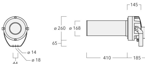
IP66, SKI. SKII auf Anfrage. IK07. Korrosionsbeständiger Aluminiumguss. PCS beschichtete Edelstahlschrauben. 5CE Korrosionsschutz. CCG® Silikondichtung. Sicherheitsglas. Eine Kabelverschraubung, eine zweite Kabelverschraubung zur Durchverdrahtung auf Anfrage. PMMA LED Linse. Eingebaute LED Platine, austauschbar. Eingebaute elektronische Betriebsgeräte, thermisch getrennt.
