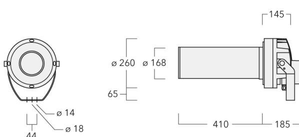
IP66. Classe I. Classe II sur demande. IK07. Corps en fonte d'aluminium. Visserie inox avec traitement PCS. Protection contre la corrosion 5CE. Joint silicone. Verre de sécurité. Circuit LED installé en usine. (Dé)montage facile sans dérégler le train optique. Une entrée de câble (seconde entrée en option, sur demande). Driver électrique séparé thermiquement, protection surtension 6/6kV intégrée. Motif GOBO (verre ou métal) à commander séparément.
