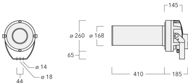
IP66, SKI. SKII auf Anfrage. IK07. Korrosionsbeständiger Aluminiumguss. PCS beschichtete Edelstahlschrauben. 5CE Korrosionsschutz. CCG\_R\_Silikondichtung. Sicherheitsglas. Eine Kabelverschraubung, eine zweite Kabelverschraubung zur Durchverdrahtung auf Anfrage. Eingebaute elektronische Betriebsgeräte, thermisch getrennt. Eingebaute RGBW/RGBA LED Platine, austauschbar. CAD-optimierte PMMA LED Linsen.
