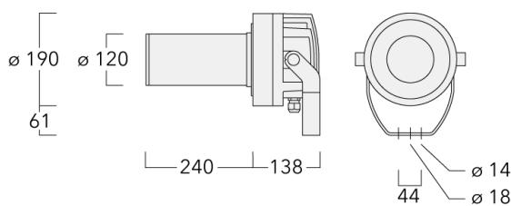
IP66, SKI, IK07. Korrosionsbeständiger Aluminiumguss. PCS beschichtete Edelstahlschrauben. 5CE Korrosionsschutz. CCG® Silikondichtung. Sicherheitsglas. Eine Kabelverschraubung, eine zweite Kabelverschraubung zur Durchverdrahtung auf Anfrage. PMMA LED Linse. Eingebaute LED Platine, austauschbar. Eingebaute elektronische Betriebsgeräte, thermisch getrennt.
