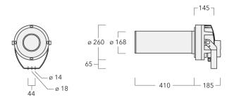
IP66. Classe I. IK07. Corps en fonte d'aluminium. Visserie inox avec traitement PCS. Protection contre la corrosion 5CE. Joint silicone. Verre de sécurité. Circuit LED installé en usine. (Dé)montage facile sans dérégler le train optique. Une entrée de câble (seconde entrée en option, sur demande). Driver électronique séparé thermiquement, protection surtension 6/6kV intégrée.
