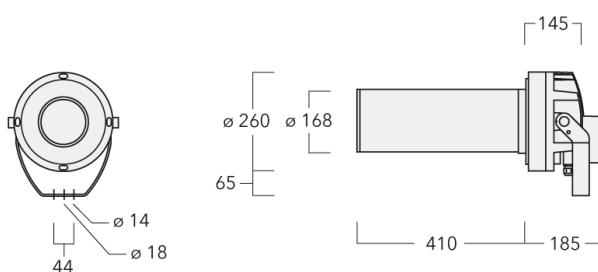
IP66. Classe I. IK07. Classe II sur demande. Corps en fonte d'aluminium. Visserie inox avec traitement PCS. Protection contre la corrosion 5CE. Joint silicone. Verre de sécurité. Circuit LED installé en usine. (Dé)montage facile sans dérégler le train optique. Une entrée de câble (seconde entrée en option, sur demande). Driver électrique séparé thermiquement, protection surtension 6/6kV intégrée.
