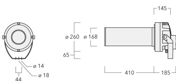
IP66. Classe I. Classe II sur demande. IK07. Corps en fonte d'aluminium. Visserie inox avec traitement PCS. Protection contre la corrosion 5CE. Joint silicone. Verre de sécurité. Circuit LED installé en usine. (Dé)montage facile sans dérégler le train optique. Une entrée de câble (seconde entrée en option, sur demande). Driver électrique séparé thermiquement, protection surtension 6/6kV intégrée.
