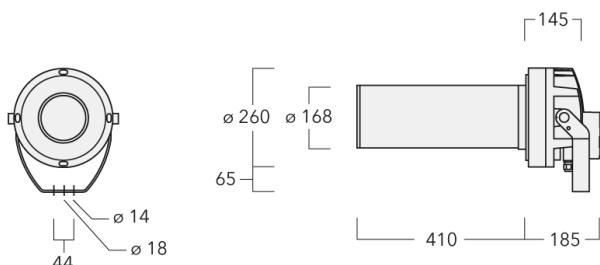
IP66, SKI. SKII auf Anfrage. IK07. Korrosionsbeständiger Aluminiumguss. PCS beschichtete Edelstahlschrauben. 5CE Korrosionsschutz. CCG® Silikondichtung. Sicherheitsglas. Eine Kabelverschraubung, eine zweite Kabelverschraubung zur Durchverdrahtung auf Anfrage. Eingebaute elektronische Betriebsgeräte, thermisch getrennt. Eingebaute LED Platine, austauschbar. CAD-optimierte PMMA LED Linsen. DALI Schnittstelle.
