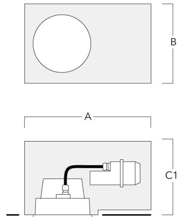
**Einbautopf, bündig mit Schattenfuge - reduzierte Einbautiefe**
