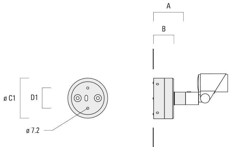
**FLC301 - embout adaptable****Accessoires Optiques****Lentille ovalisante**
