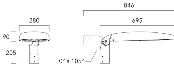
Fixation orientable top de mât Ø60 pour EVO 841-9010 7.20
