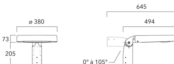
Fixation orientable top de mât Ø60 pour ODO
