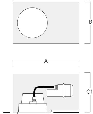
**Einbautopf, bündig mit Schattenfuge - reduzierte Einbautiefe**
