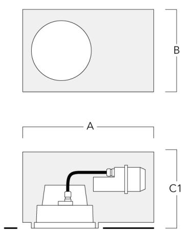
**Einbautopf, bündige - reduzierte Einbautiefe**
