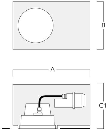
**Einbautopf, erhaben - reduzierte Einbautiefe**
