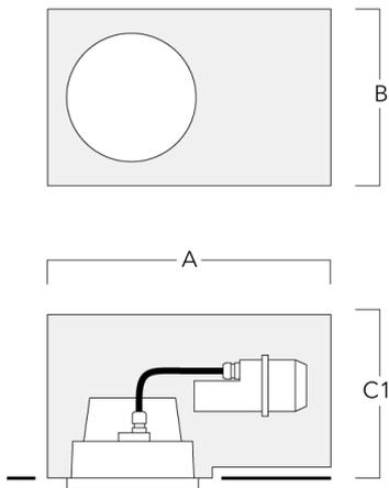
**Einbautopf, bündig mit Schattenfuge - reduzierte Einbautiefe**
