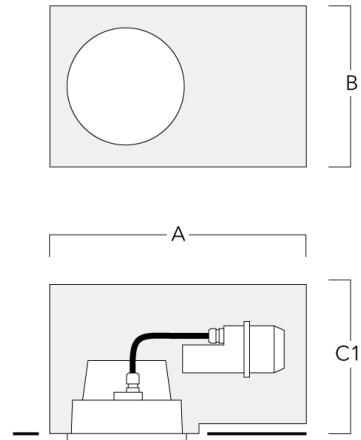
**Einbautopf, bündig mit Schattenfuge - reduzierte Einbautiefe**
