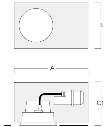
**Einbautopf, erhaben - reduzierte Einbautiefe**
