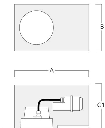
**Einbautopf, bündig mit Schattenfuge - reduzierte Einbautiefe**
