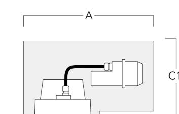
**Einbautopf, bündig mit Schattenfuge - reduzierte Einbautiefe**
