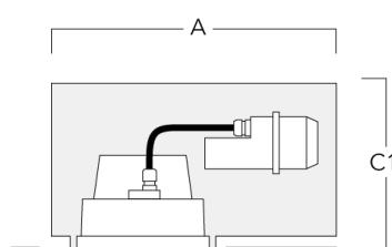
**Einbautopf, erhaben - reduzierte Einbautiefe**
