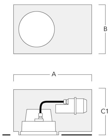
**DOC240 LED****Einbautopf, bündige - reduzierte Einbautiefe**
