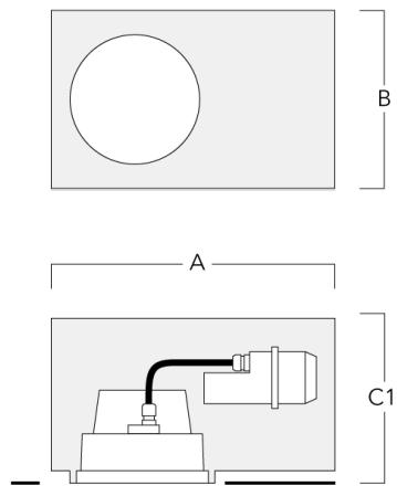
**Einbautopf, erhaben - reduzierte Einbautiefe**
