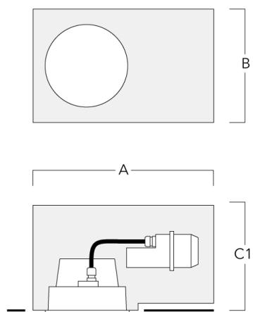
**Einbautopf, bündig mit Schattenfuge - reduzierte Einbautiefe**
