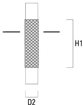
**Zylindrisch abgesetzt - verzinkter Stahl**
