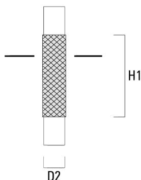
**Zylindrisch abgesetzt - verzinkter Stahl**
