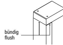
12) Die versenkten Schrauben **N** schrittweise in abwechselnder Reihenfolge (6 Nm) mit dem Torx 30 anziehen. Die Senkschrauben **J** wieder in den Kopf einsetzen und festziehen.
