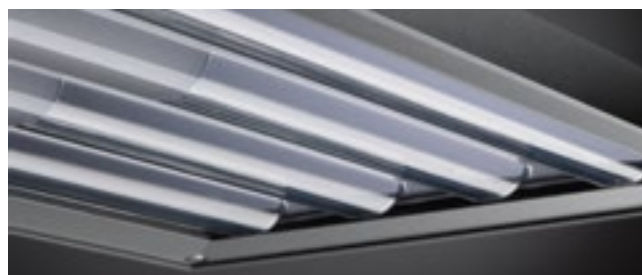
Vitre RFC® : Le contour de la vitre épouse la forme de chaque lentille LED, réduisant ainsi les réflexions internes dans le luminaire.
