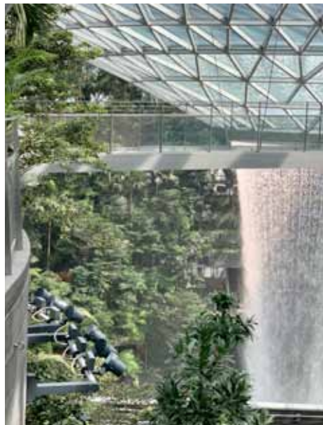
02 Angesichts der in dem terrasierten Park auf 360° und verschiedene Höhenniveaus verteilten Beobachterstandorte war eine besonders wirksame Entblendung gefragt. So sind hier fast alle FLC Scheinwerfer mit Abblendtuben ausgestattet.
